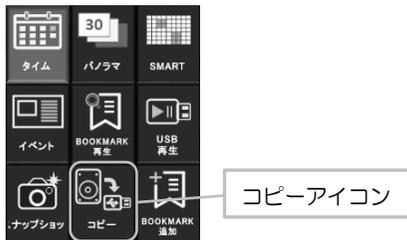
3. ①チャンネル選択→開始時間選択→終了時間選択→デバイス選択→タイプ選択→TAG 指定(任意)→パスワード(任意)の順で指定し、コピースタートを選択
